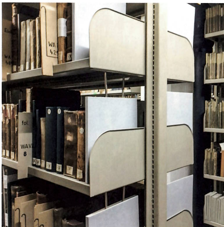
Ein verbesserter Lichtschutz wird wie folgt erreicht: Buchstützen mit einer Ummantelung aus säurefreier Mikrowellpappe, die gleichzeitig den Stand der Bücher stabilisieren (links im Bild), und am Regalanfang und -ende lose eingestellte Mikrowellpappen (r.).
